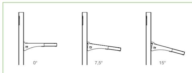
I reggipiani permettono di posizionare i ripiani sia orizzontali che inclinati, di 7,5° o 15°.
